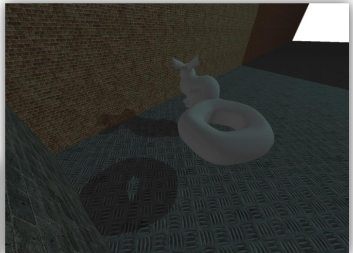
Figure 10 : Exemples d'application de la méthode des shadow map dans le moteur de deferred rendering
